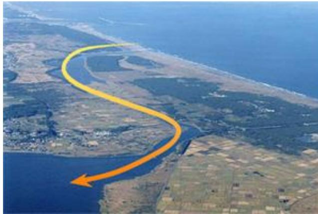
潮位が湖水位より高くなると、塩水の侵入が始まります(その1、その2)。その後、潮位が湖水位より低くなると大部分の塩水は太平洋へと戻っていきませんが、プランジングポイントと呼ばれる境界点を越えた塩水は小川原湖の浅瀬部分に貯まります(その3)。さらに、小川原湖内のマウンド部分を超えた塩水は、底層密度流と呼ばれる流れとなって、湖底に侵入していきます(その4)。
