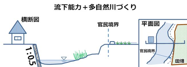
図-2 川づくりにおける横断面の検討方法の一例
